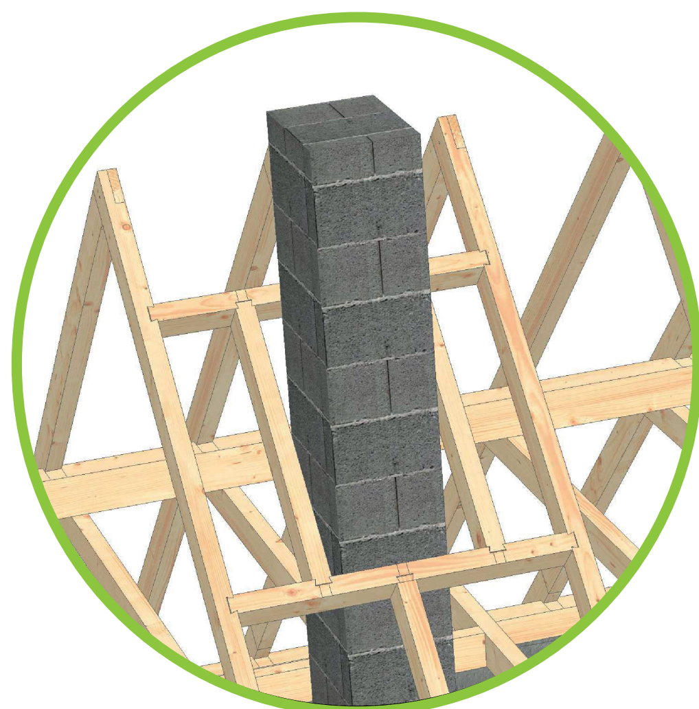
WYMIAN KOMINA Z ZASTOSOWANIEM POŁĄCZEŃ NA „JASKÓŁCZY OGON”
